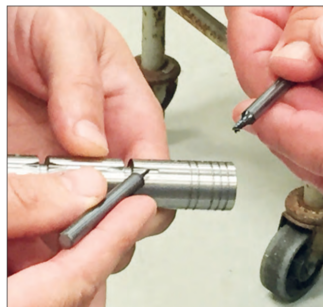
Det særlige fræsespor i gliderne kan produceres i foreløbigt hen ved 750 forskellige varianter på cellen.
